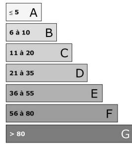
Мера измерения : kWhEP/m<sup>2</sup>.an
